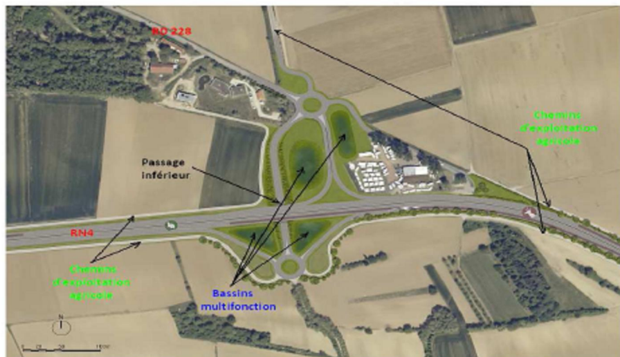
Figure 7: Photomontage représentant une solution d'aménagement possible du carrefour dénivelé entre RN4 et RD228
